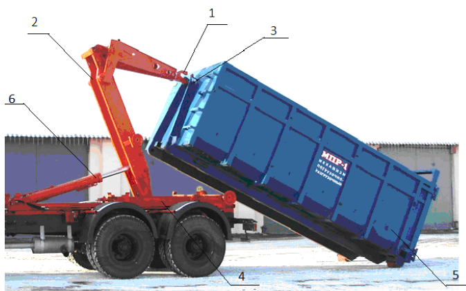
Рис. 4.2. Мультилифт с крюковым захватом: 1 – крюк, 2 – Г-образная балка, 3 – дышло, 4 – подрамник, 5 – контейнер, 6 – гидроцилиндр
