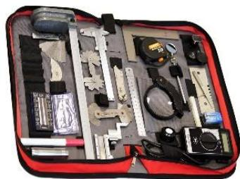
Рис. Оборудование для ВИК
