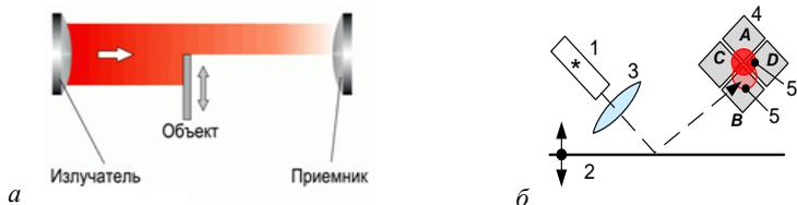
Рис. Схемы оптического датчика малых приближений
