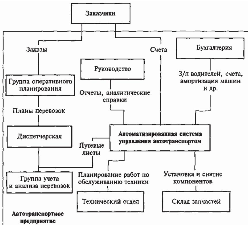
Рис. 1.6. Схема информационных потоков при управлении автотранспортом
