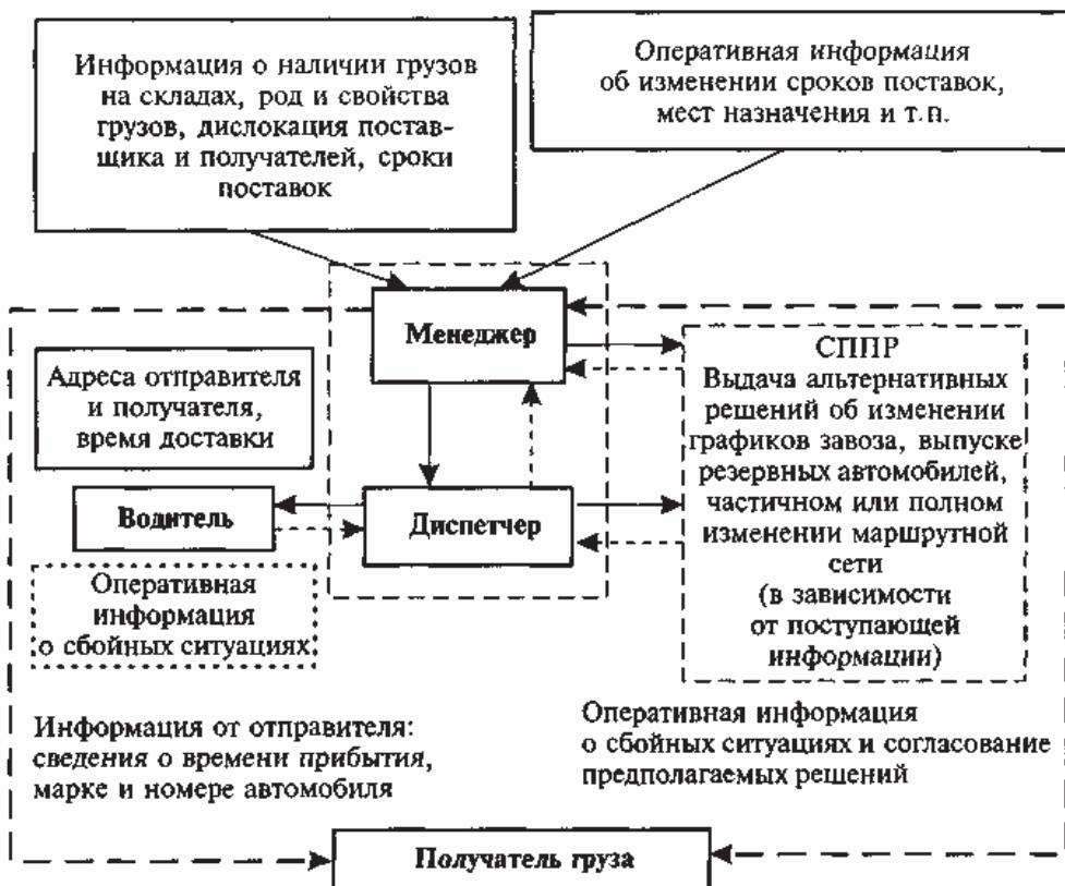
**Рис. 1.2. Схема информационных потоков в системе доставки грузов**
