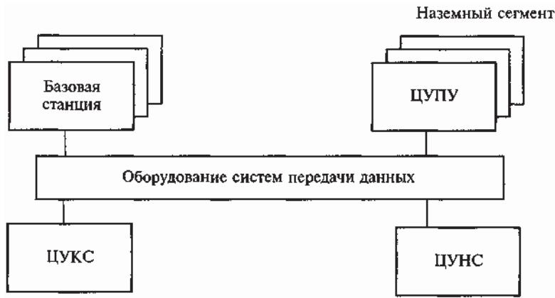
**Рис. 5.3. Структурная схема взаимодействия элементов наземного сегмента спутниковой системы связи**
