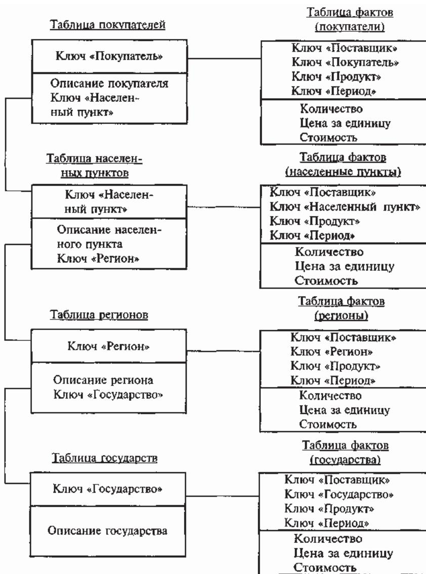
Рис. 1.5. Пример схемы "снежинка" (фрагмент для одного измерения)
