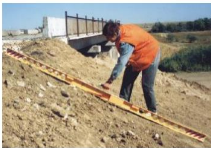
Рисунок 1 – Определение коэффициента заложения откоса земляного полотна с помощью универсальной рейки
