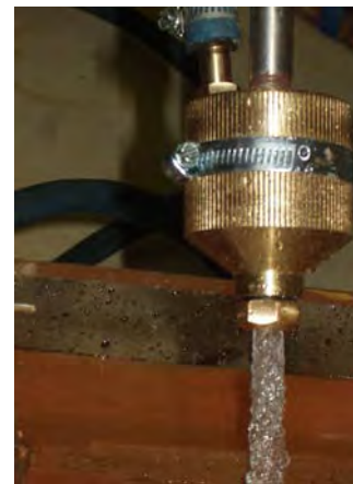
Рис. 3. Форсунка для струйной аэрации
