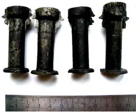
Рис. 7. Внешний вид поковок пуансонов штампов для холодной пробивки отверстий, изготовленных методом СГВ с ПТЧ в режиме ВТМО: v_0 = 62 м/с; T_0 = 1150 °С; 2\alpha = 90^\circ ; \lambda = 4 ; \eta = 4,3 ; материал основы – сталь 40Х; плакирующий слой – сталь 9ХС
