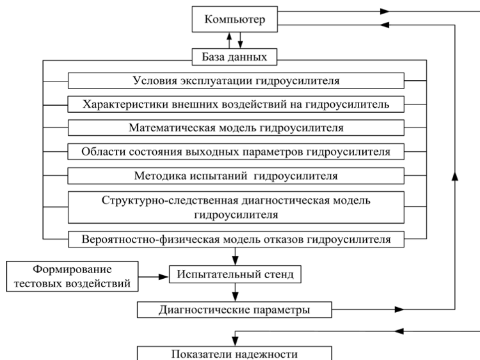
Рис. 1. Алгоритм прогнозирования параметрической надежности гидроусилителя рулевого управления
