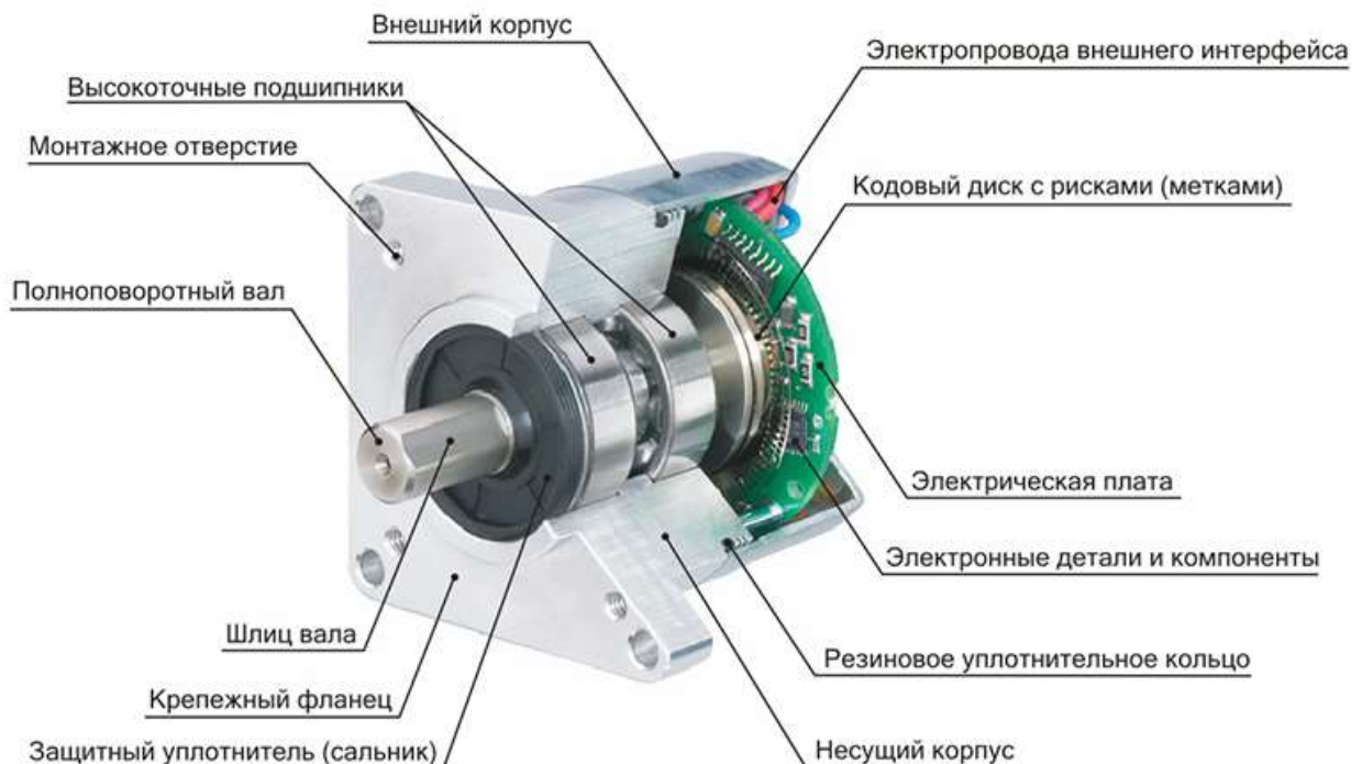
Рисунок 1. Устройство энкодера
