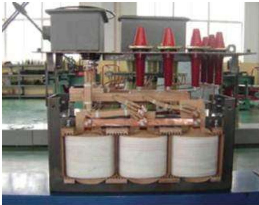
Рисунок 6. Трехфазный распределительный трансформатор мощностью 1600 кВ·А с сердечником из аморфного сплава
