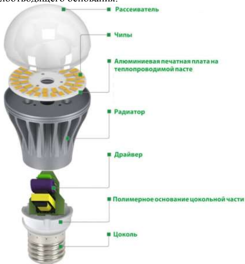
Рисунок 1 – Конструкция светодиодной лампы
