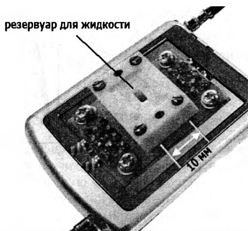
Рис. 4. Лабораторный электронный язык на ПАВ.
