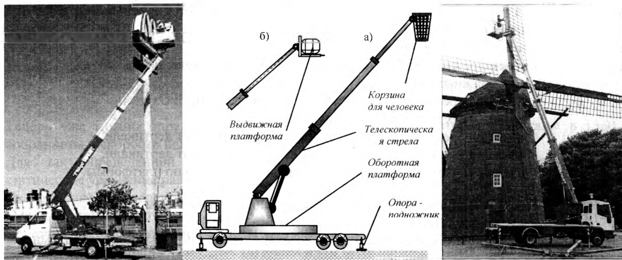
Рис. 2. Подъёмник-вышка во время работы и его схема
