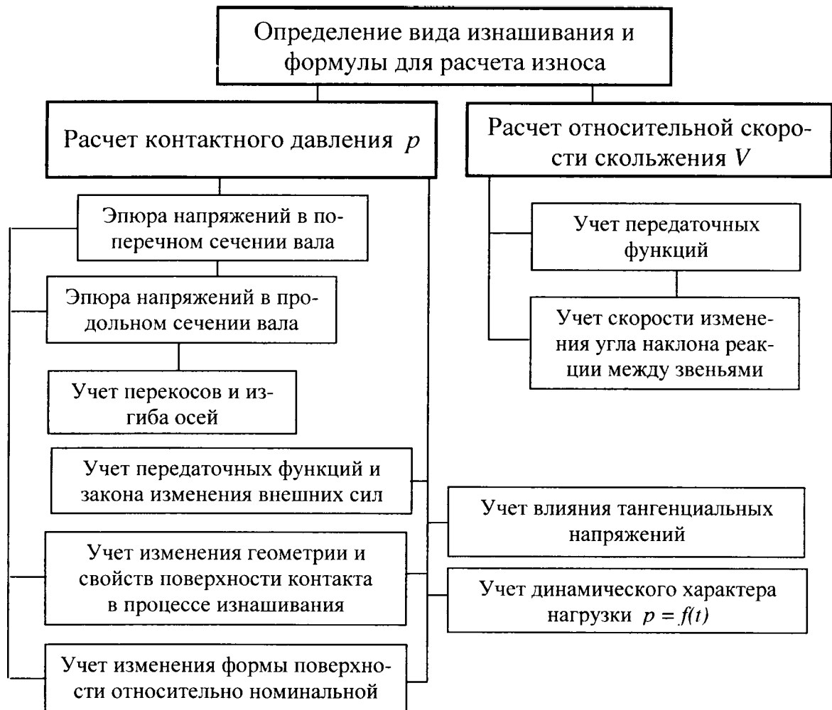
Рис. 1. Схема расчета вращательных пар на износ
