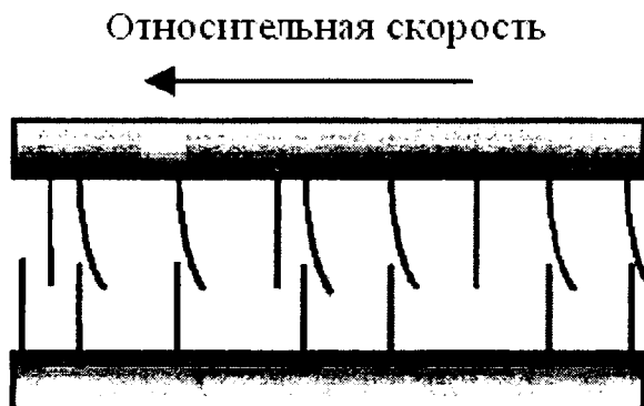
Рис. 4. Фрикционное взаимодействие в модели LuGre
