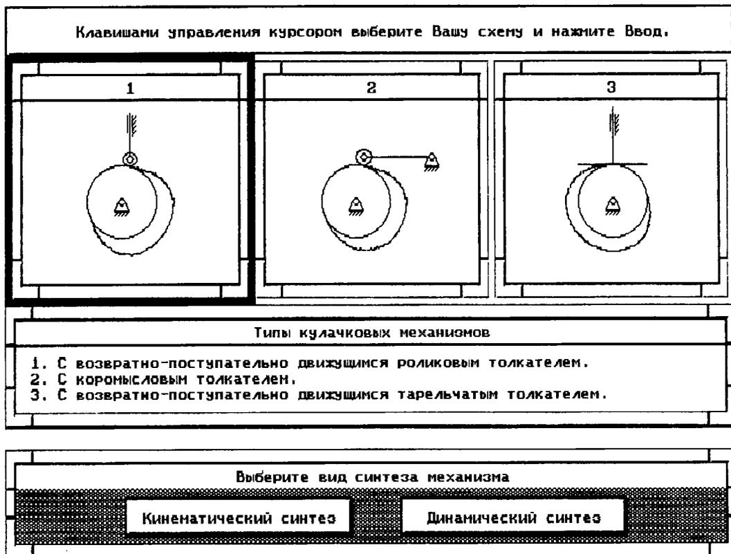
*Рис. 1. Выбор схемы проектируемого механизма и вида синтеза*
