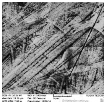
Рис. 8. Электронно-микроскопические фотографии поверхности образца при различных режимах обработки: a – без обработки; б – постоянный ток; в – положительные импульсы; г – биполярные импульсы. \times 2500
