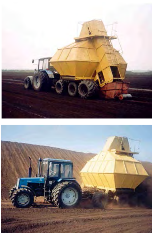
Рис. 3. Испытания уборочной машины на пневмоколесном ходу
