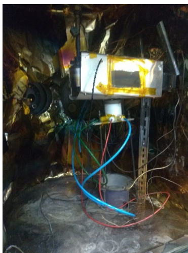
Рисунок 2 – Технологическая система для получения алмазоподобного покрытия на керамическом образце
