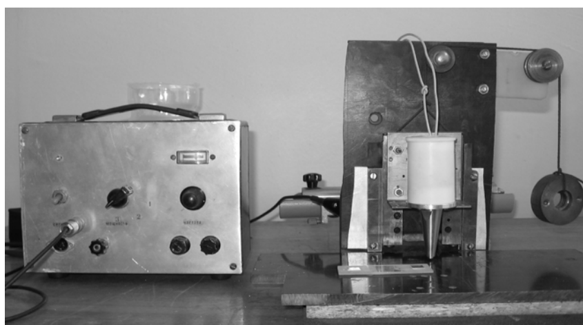
Рис. 1. Установка для моделирования процесса снятия зубных протезов при ультразвуковом виброударном воздействии: а – схема конструкции; б – внешний вид
