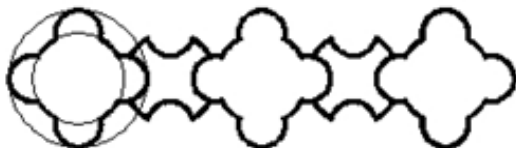
Рисунок 2 – Профили, полученные последовательной обкаткой симметрично-кругового профиля
