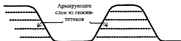
Рис. 1. Схема армирования откосов
