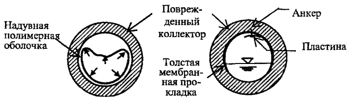
Рис. 6. Ремонт трубы с помощью геомембранной обшивки
