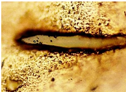
Рисунок 1 - Игольчатая скобка, возникающая на поверхности шлифа в процессе прошивки (режим СГП) стали сгустками порошка карбида кремния в алюминиевой оболочке, × 400
