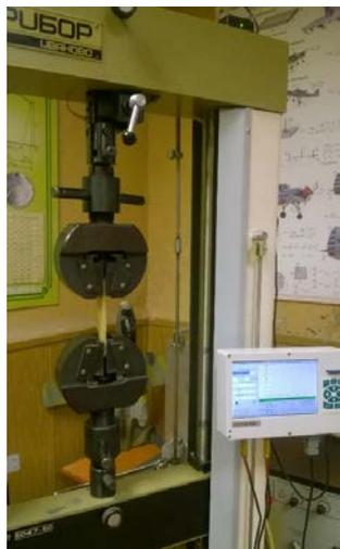
Рис. 4. Испытание на растяжение на разрывной машине ИР-5047-50
