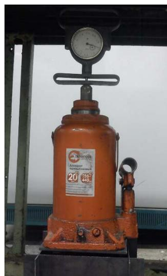
Рис. 3. Установка для выдержки изделия под нагрузкой
