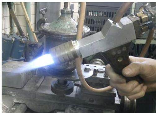
Рис. 2. Установка газопламенного напыления ТРУ-БПИ
