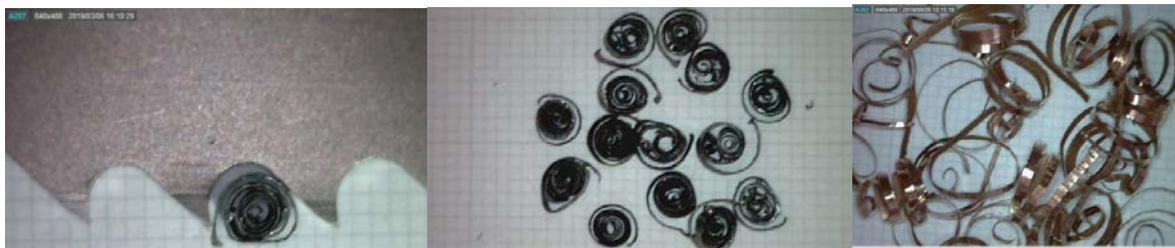
Рис. 3. Формы стружек при пилении бронзы
