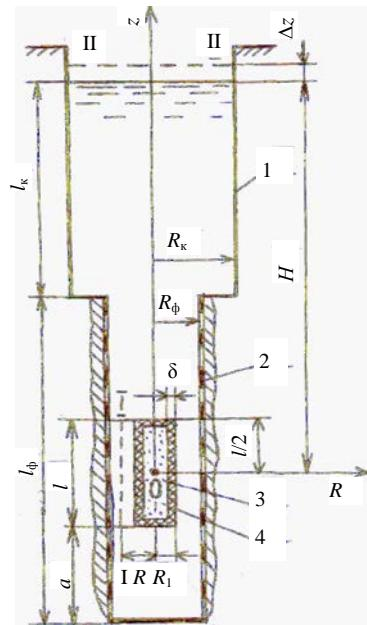
Рис. 1. Расчетная схема пульсаций цилиндрической взрывной камеры в фильтре скважины 1 – обсадная колонна; 2 – фильтр; 3 – цилиндрическая взрывная камера; 4 – оболочка
