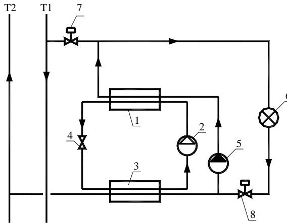
Рис. 2. Схема использования ТНУ в теплопотребляющих системах теплофикационного комплекса города: 1 – конденсатор; 2 – компрессор; 3 – испаритель; 4 – дроссель; 5 – смесительный насос; 6 – потребитель; 7 – регулятор температуры; 8 – регулятор расхода
