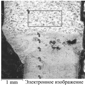
Рис. 9. Зоны определения химического состава образца: v = 450 мм/мин; \Delta F = -5 мм; \Delta t = -0,1 мм
