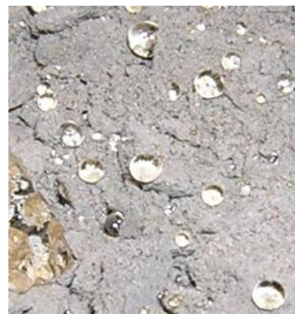
Рис. 5. Конденсация водяного пара при хранении гидрофобно-модифицированного цемента в условиях 100%-й влажности воздуха
