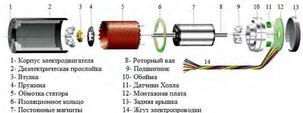
Рисунок 4 – Конструкция вентильного двигателя
