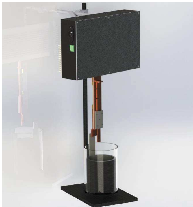
Рисунок 3 – Общий вид блока ключа, установленного над ёмкостью с электролитом (3D модель)
