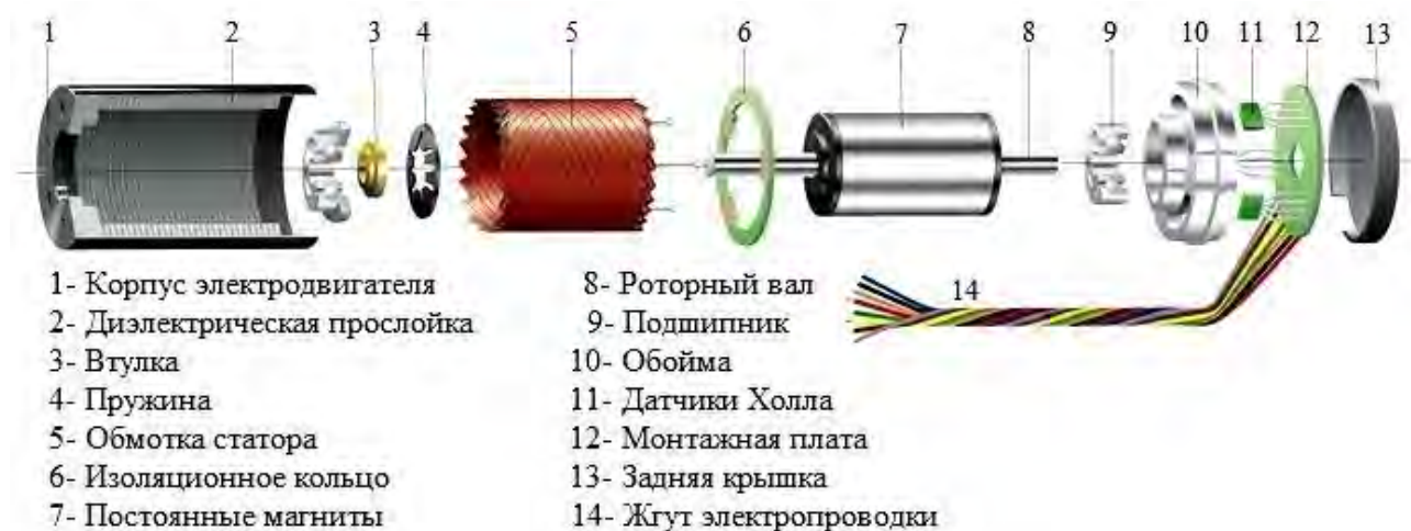
Рисунок 4 – Конструкция вентильного двигателя
