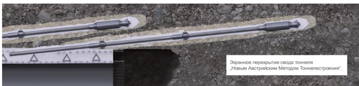
Рисунок 1 – Экранное перекрытие свода туннеля
