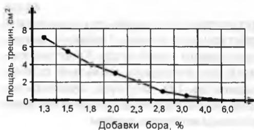
Рис. 2. Влияние добавок бора на трещиностойчивость стали
