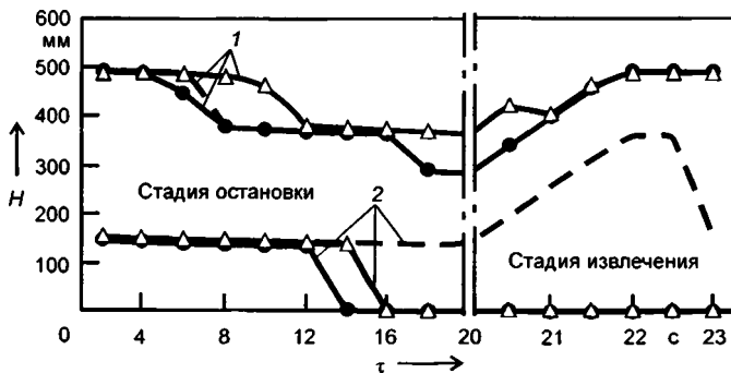
Рис. 2. Изменение глубины лунки при различной интенсивности охлаждения кристаллизатора и отливки:
