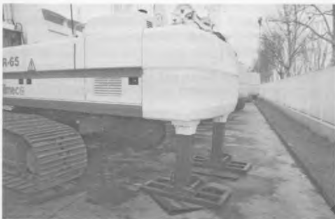
Рис. 10. Аутригеры к буровой машине SR-65 фирмы Soilmes
