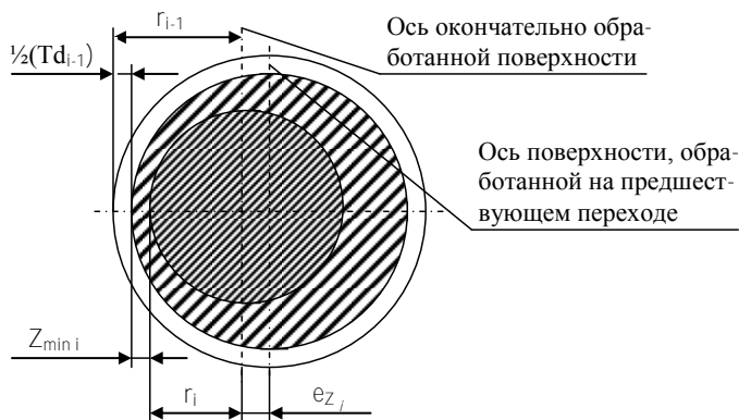
Рис. 57. Схема к расчету диаметров обрабатываемых поверхностей
