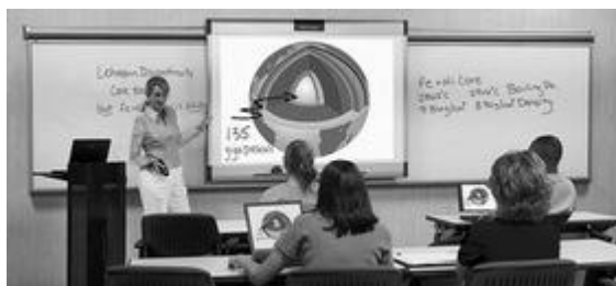
Рис. 3.9. Современная электронная доска прямой проекции
