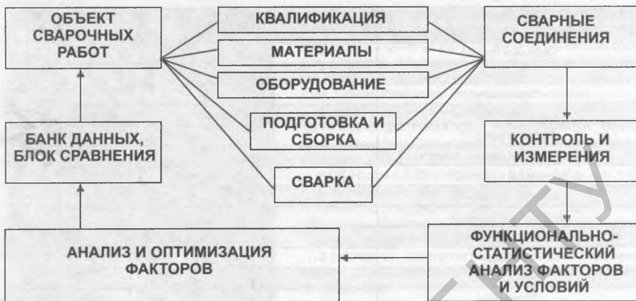
Рис. 1 Схема-модель исследования образования дефектности в сварном соединении
