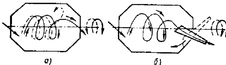
Рис. 2.52. Схемы неопрокидных бетоносмесителей: а - реверсивного; б - с выгрузочным лотком
