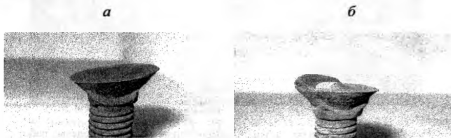
Рис. 11. Степень износа болтов, установленных на лемеха корпуса плуга: а – диффузионное покрытие; б – наплавка
