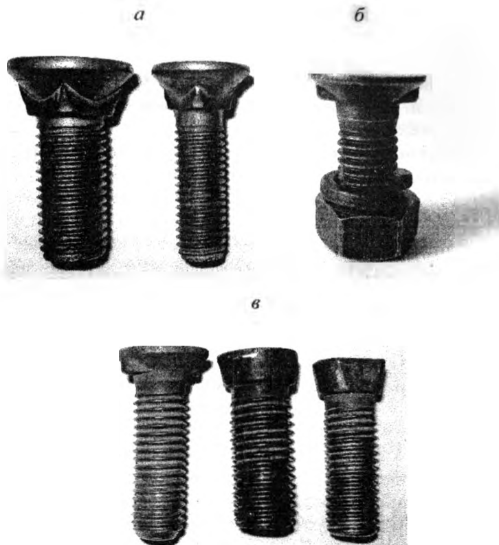
Рис. 1. Крепежные элементы корпусов плугов: а – МЗШ (сталь 20); б – Kverneland; в – МЗШ (сталь 40Х)
