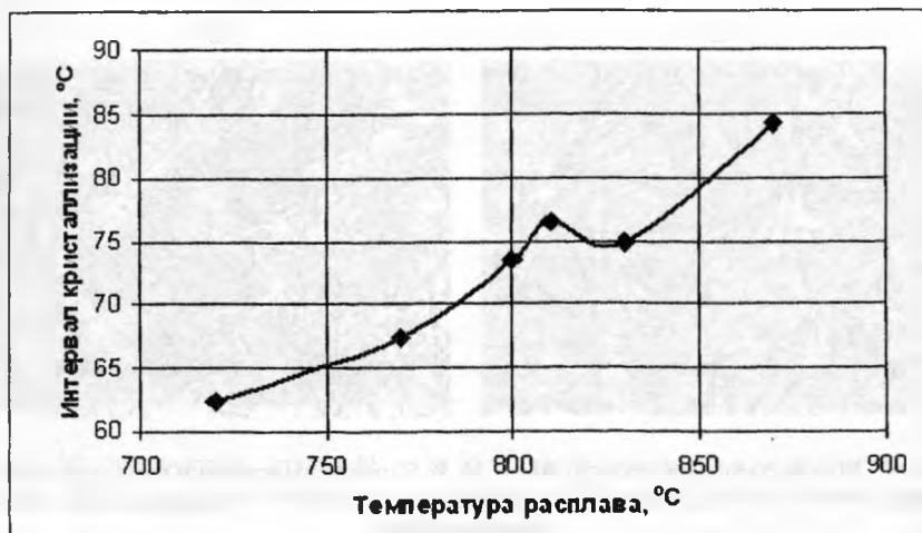
Рис. 2. Зависимость интервала кристаллизации сплава Al – 16 % Si от температуры перегрева сплава в жидком состоянии
