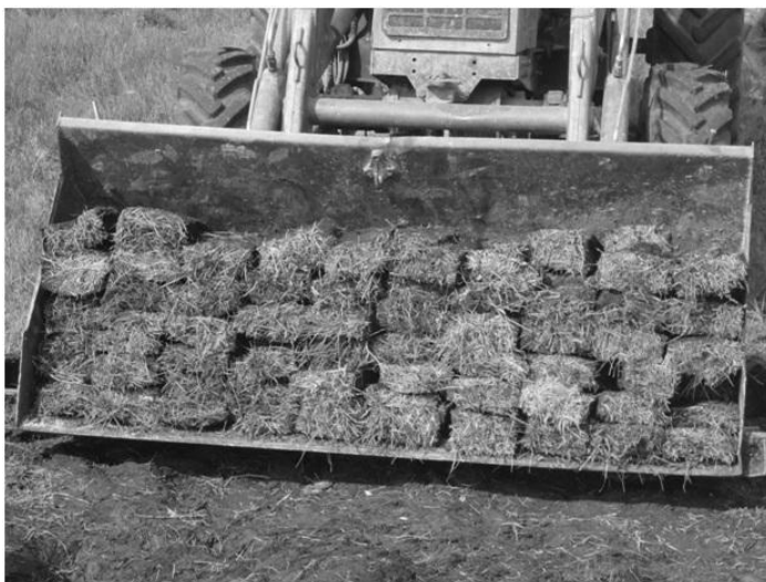
Рис. 2 – Использование тракторного погрузчика для транспортировки резного торфа к месту сушки
