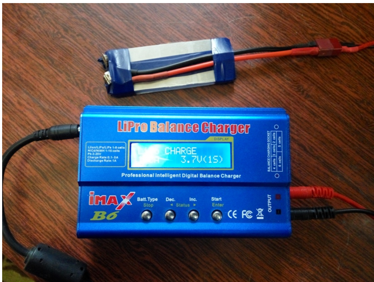
Рисунок 1 – Испытание первого макета графенового аккумулятора
