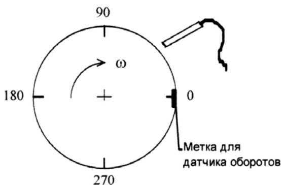
Рис. 2.6. Разметка балансировочной плоскости
