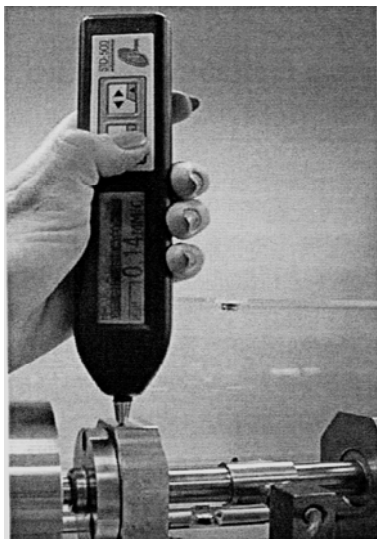
Рис. 1.10. Проведение измерений виброколлектором STD-500
