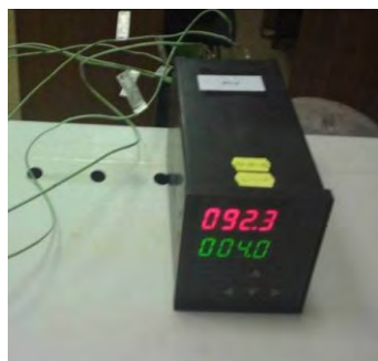
Рисунок 22 – Устройство контроля температуры «УКТ38»
