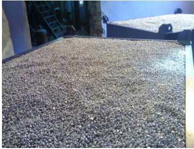
Рисунок 3 – Завершающая стадия получения «сухих» гранул ( a ) и алюминиевые гранулы, готовые к отгрузке ( б )
