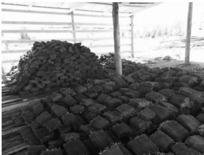
Рис. 3 – Сушка торфяных кирпичей под навесом
