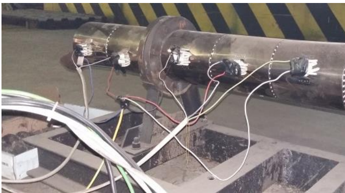
Рис. 7 – Определение датчика, который необходимо нагревать отдельно от всех, с регулируемой подачей тепла
