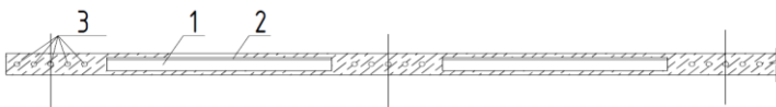
Рис. 2 – Схематичный разрез устройства плитного фундамента рамной конструкции с предварительным напряжением арматуры в построечных условиях (1 – ячейки полости, 2 – крышка-опалубка, 3 – каналообразователи с напрягаемой арматурой)
