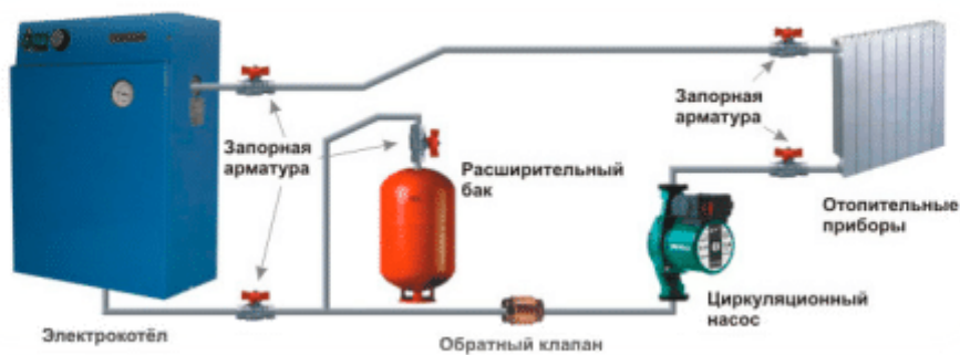
Рисунок 2 – Пример монтажа отопления с электродом
