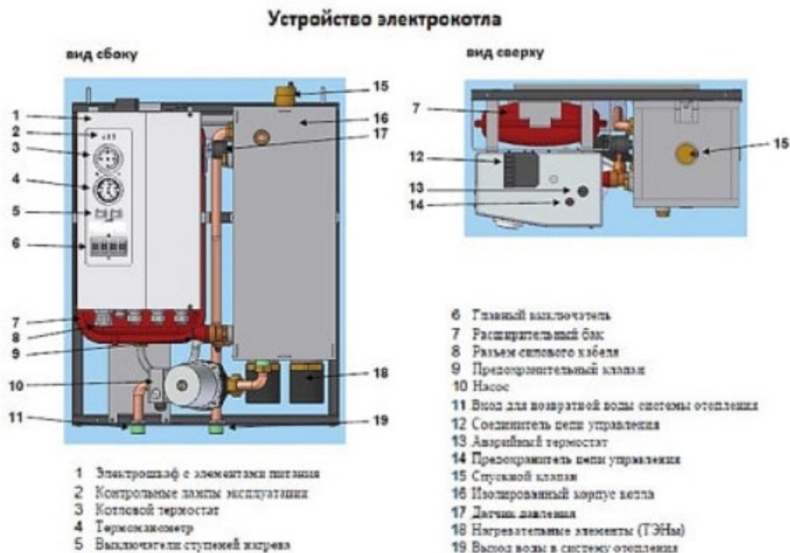
Рисунок 3 – Устройство стандартного электрического котла
