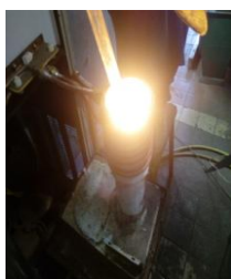
Рисунок 1 – Слитки силицидов, полученные восстановительной плавкой (СВС-процессе)
