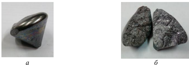
Рисунок 2 – Слиток силицида титан-кремний-никель (а) и макроструктура (б), полученного высокоскоростной индукционной плавкой
