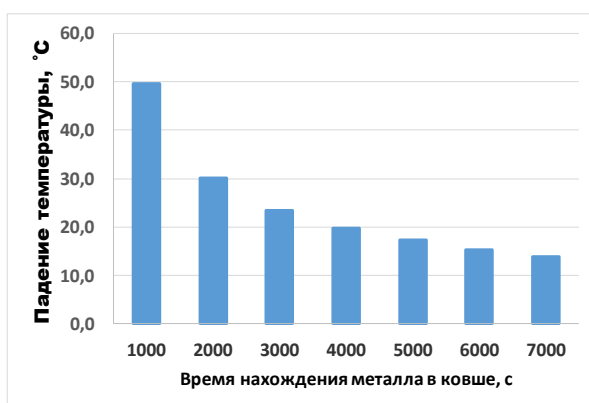
Рисунок 7 – Зависимость падения температуры стали в ковше от времени нахождения металла в ковше в первом цикле
