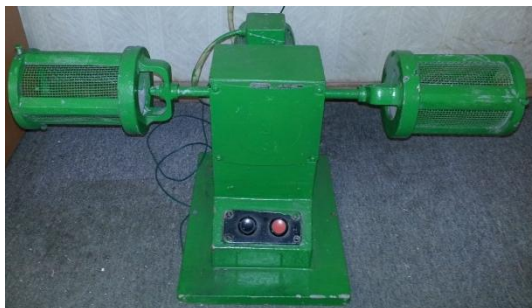
Рисунок 5 – Установка для оценки осыпаемости стержней
