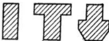
Рис. 4.25. Схемы поперечного сечения сборного ригеля
