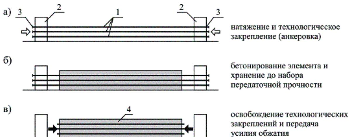
Рис. 2.19. Последовательности технологических операций при предварительном напряжении арматуры на упоры
