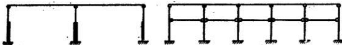
Рис. 5.5. Схема поперечной и продольной рамы
