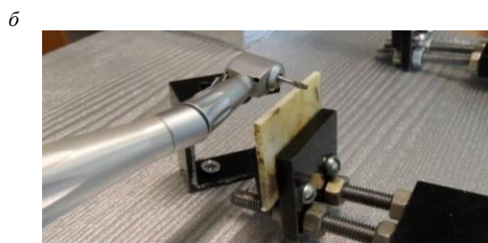
Рисунок 2 – Схема устройства определения режущей способности бора (а) и фотография его рабочей зоны (б)
