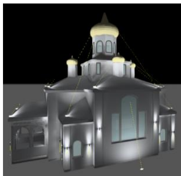
Рисунок 2 – 3D проект (DIALux EVO) храма с использованием многоуровневой системы подсветки
