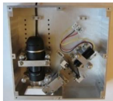
Рисунок 4 – Фотография оптического блока профилометрического устройства со снятой крышкой
